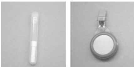
図3 パッシブサンプラー(ホルムアルデヒド用)左 (VOC 用)右
